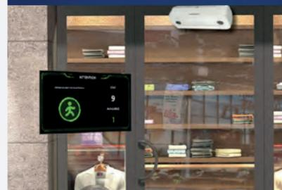
Les visiteurs sont comptés avec une caméra spéciale de comptage de personnes, qui est montée au-dessus de l'entrée / sortie d'un magasin, par exemple.
